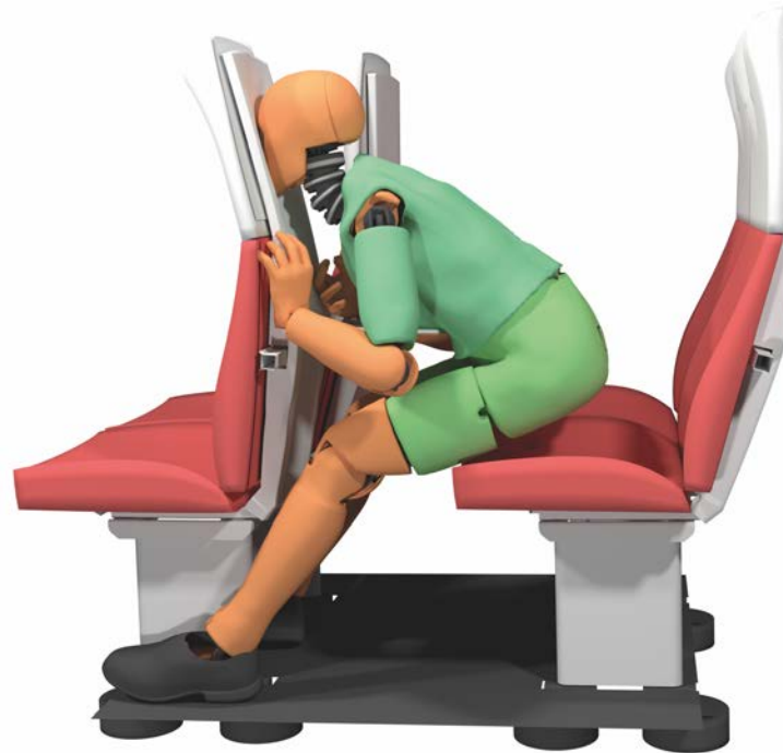
Simulace crash testů sedadel pro zlepšení pasivní bezpečnosti a komfortu cestujících v železniční dopravě, výzkum oceněný HiPEAC Technology Transfer Award
